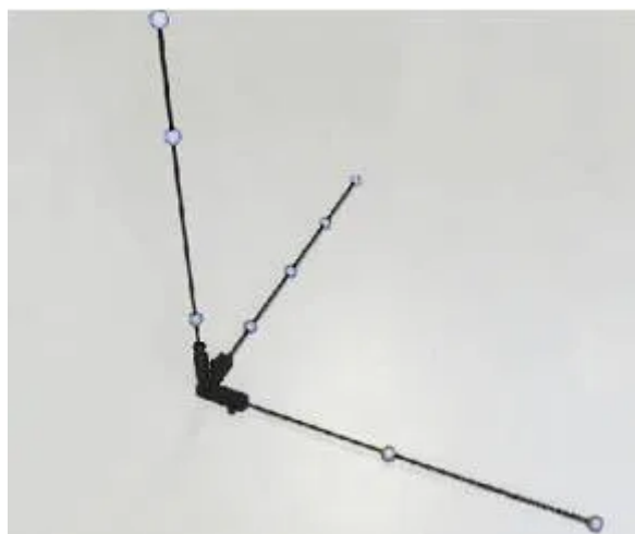
Figura 2. "Patrón" proporcionado por el fabricante para la "calibración" inicial
